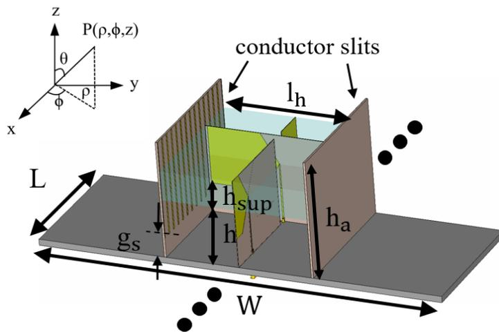
HP 소자를 위한 conductor slit 배치 (양 옆)
