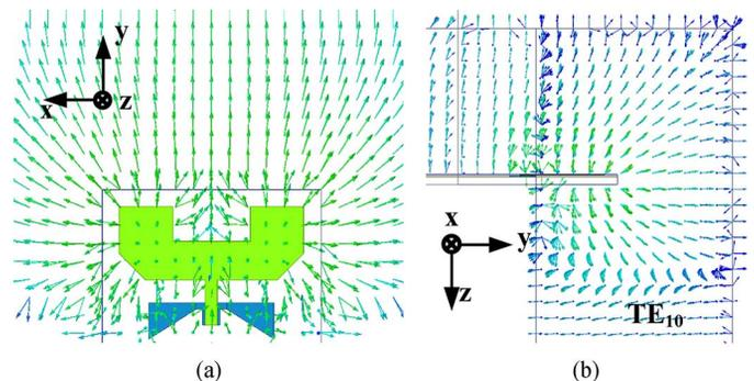
Fig. 6.  $E$ -field distribution in: (a)  $xy$ -plane and (b)  $yz$ -plane.
