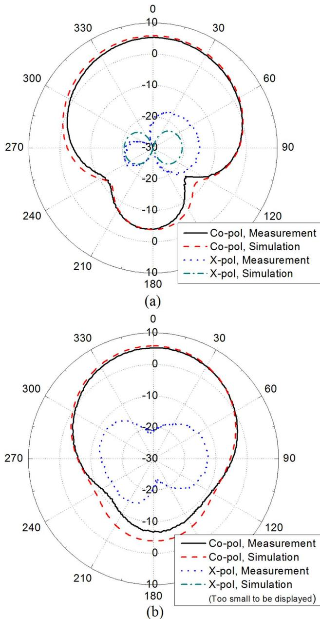
Fig. 7. Radiation patterns of the proposed antenna. (a) E-plane ( $yz$ -plane) and (b) H-plane ( $xz$ -plane) at 2.45 GHz.
